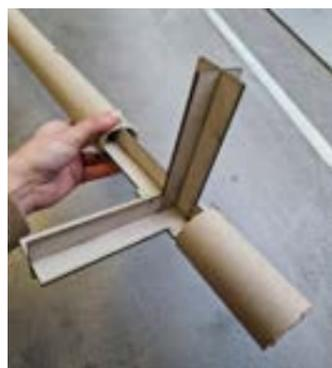
Connexions pouvant être utilisés pour la construction des modules. Fabriqué en carton et réalisé grâce à une découpe laser. L'assemblage peut facilement être répliqué dans n'importe quel territoire.
